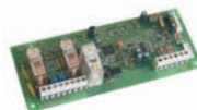
J424/J408 J400-EXT Modulo di estinzione a microprocessore - Extinguisher module with microprocessor control
